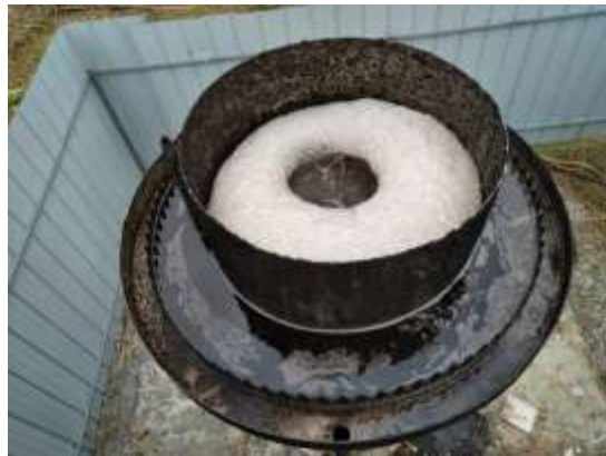
20M 3 反应器已用于四川眉山某养猪场100t/d污水处理
